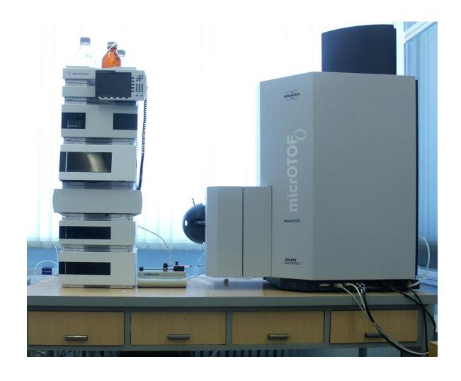
ullet Времяпролетный масс-спектрометр высокого разрешения Bruker micrOTOF  $_Q$  с жидкостным хроматографом Agilent 1100
